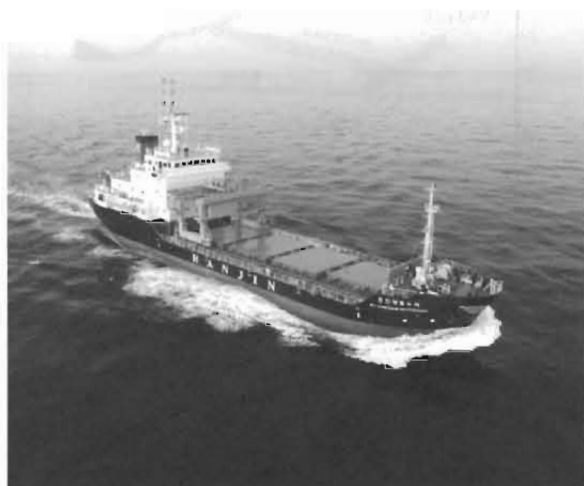
廃棄物輸送船チョンジョンヌリ号 (2600トン、二重船体、GPSシステム搭載) KRMCパンフレットより
